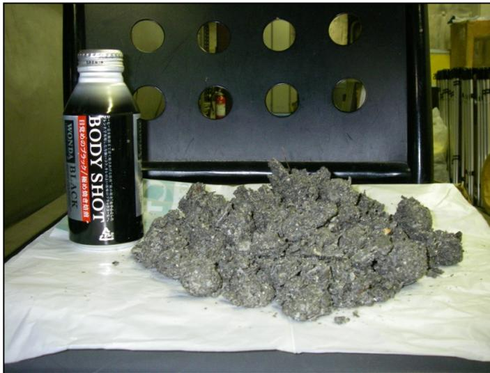
写真1-1 冷却水スラッジ回収量
