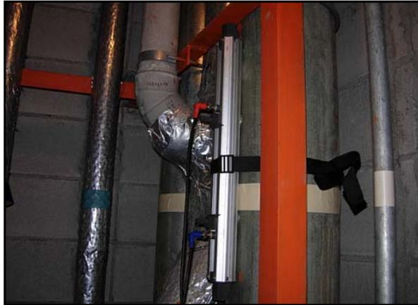
資料写真2-1 流量測定状況(センサー部)
