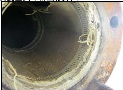
写真1 既設Yストで回収したスラッジ
